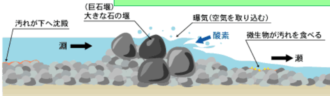
図 5.24 河川の自然浄化作用の概要図
