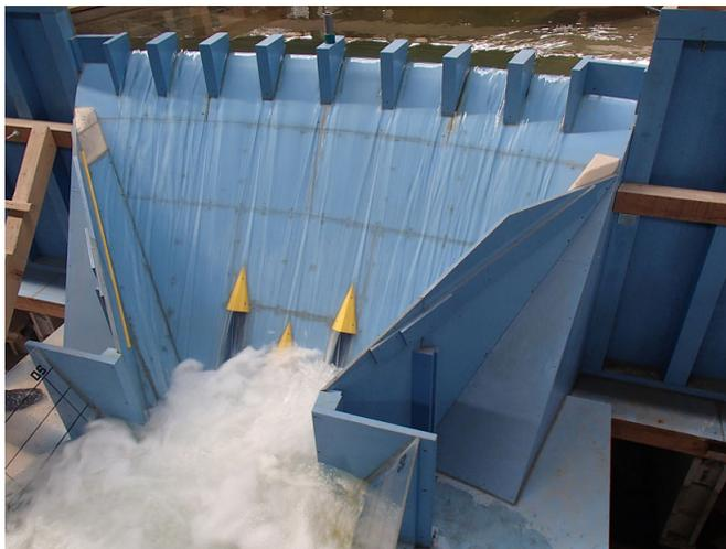
水理模型実験状況(立野ダムの事例)
