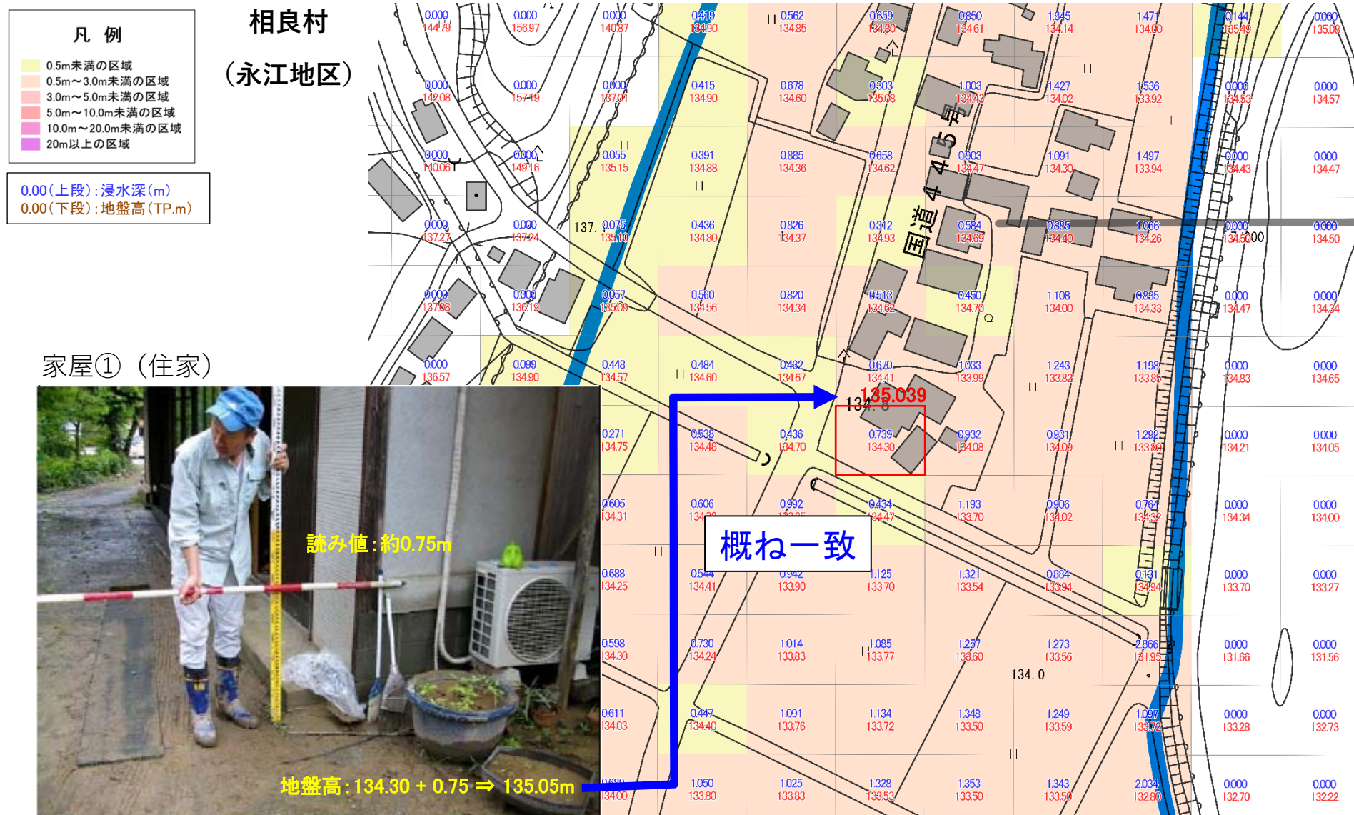
図 氾濫解析結果(R2.7出水、越水のみ) 検証図(家屋①(住家)付近拡大図)
