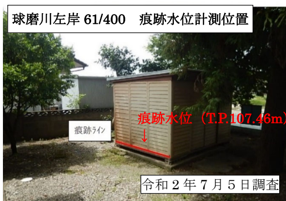
図 人吉大橋周辺における洪水痕跡水位計測状況
