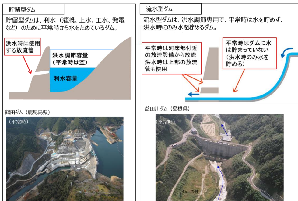
図 貯留型ダム及び流水型ダムにおける特徴
