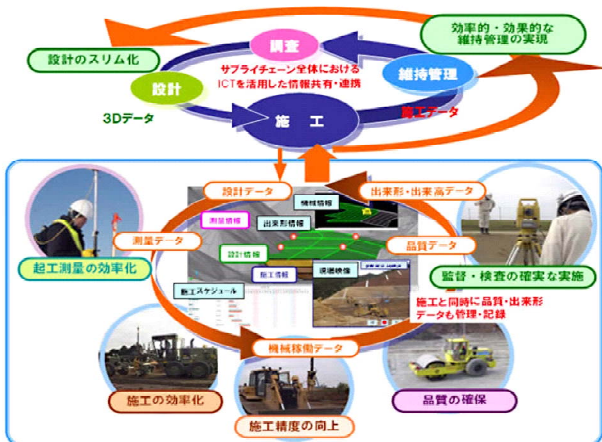
図 情報化施工の実現イメージ（情報化施工推進戦略より）
