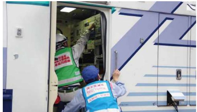
衛星通信車の設営(球磨村総合運動公園)
