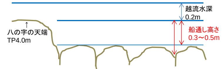
八の字の石組み(天端は凹凸がある)
