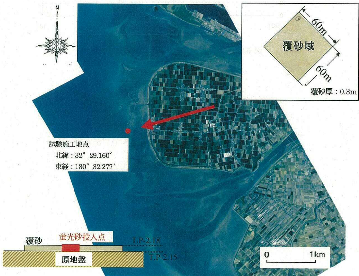
図 5.1 覆砂試験施行地点（2004 年 3 月 22 日覆砂）
